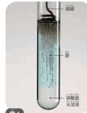
図4 硝酸銀水溶液に銅線を入れたときのようす
